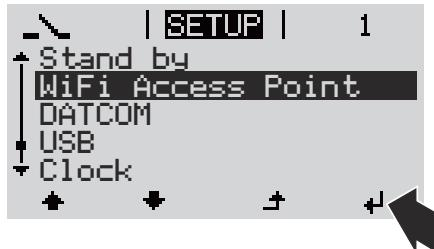
De omvormer stelt het WLAN-toegangspunt in. Het WLAN-toegangspunt blijft 1 uur geopend. De IP-schakelaar op de Fronius Datamanager 2.0 kan door activering van het WLAN-toegangspunt in schakelaarpositie B blijven.
