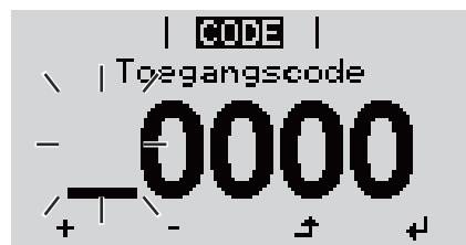
In het menu 'CODE' wordt 'Access Code' (Toegangscode) weergegeven, de eerste positie knippert.
