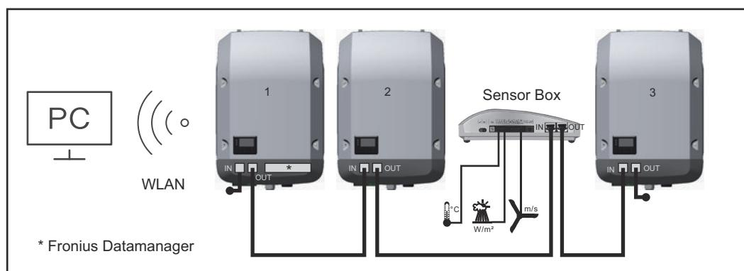
Datennetzwerk met 3 inverters en een Fronius Sensor Box:
