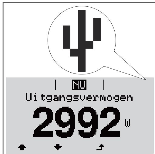
Herkent de omvormer een USB-stick, dan wordt rechtsboven op het display het USB-symbool weergegeven.
