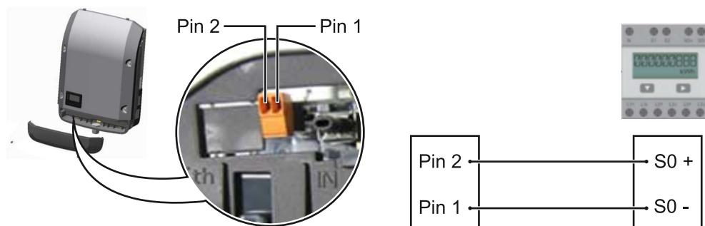
Le compteur SO doit être conforme à la norme CEI62053-31 classe B.
